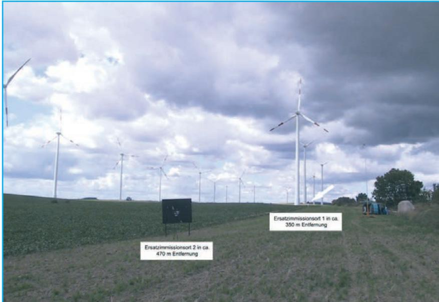
Abbildung 3: Beispiel einer Immissionsmessung mit zwei Messpunkten und Anemometer aus Richtung des Windparks
